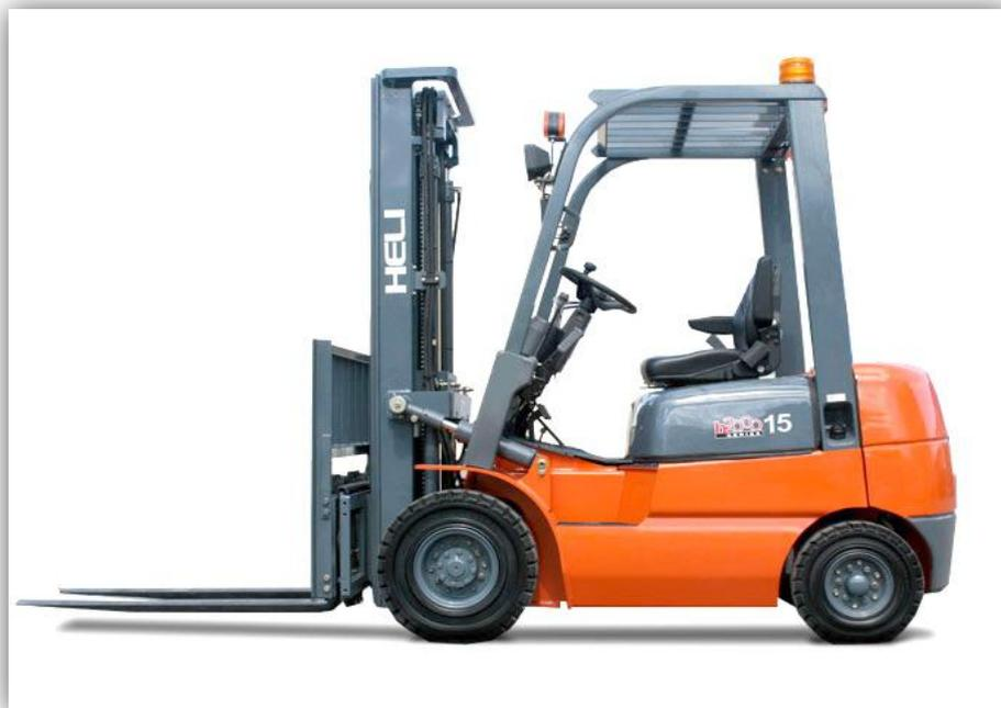
Дизельный погрузчик HELI CPCD15 - самый распространенный вид погрузчиков для обработки паллетированных грузов весом до 1,5 тонны. Адаптированная для отечественного рынка модель пользуется широкой популярностью у российских покупателей.
