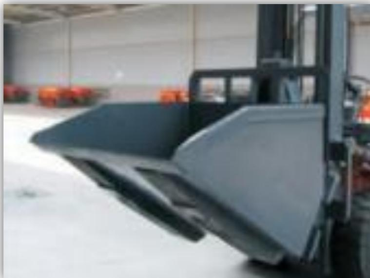
Навесной наклоняемый ковш применяется для подъема и перемещения небольших сыпучих грузов. Их транспортировка становится максимально удобной. Оборудование для автопогрузчиков от ведущего мирового производителя спецмашин HELI легко устанавливается и служит долго. Наклоняемый ковш имеет простую и надежную конструкцию.
