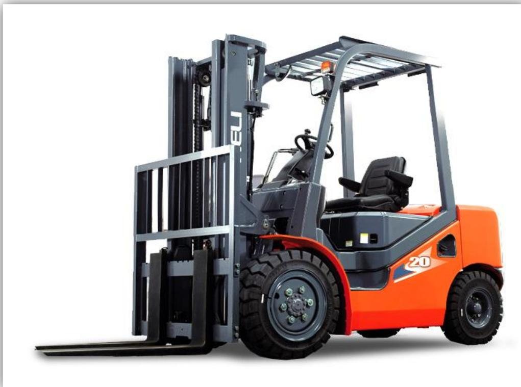
Дизельный вилочный погрузчик HELI CPCD20NH – идеальное решение задачи по обработке грузов весом до 2 тонн. Использование погрузчика HELI CPCD20NH в различных отраслях экономики позволяет оптимизировать процесс погрузки/выгрузки паллетированных товаров.
