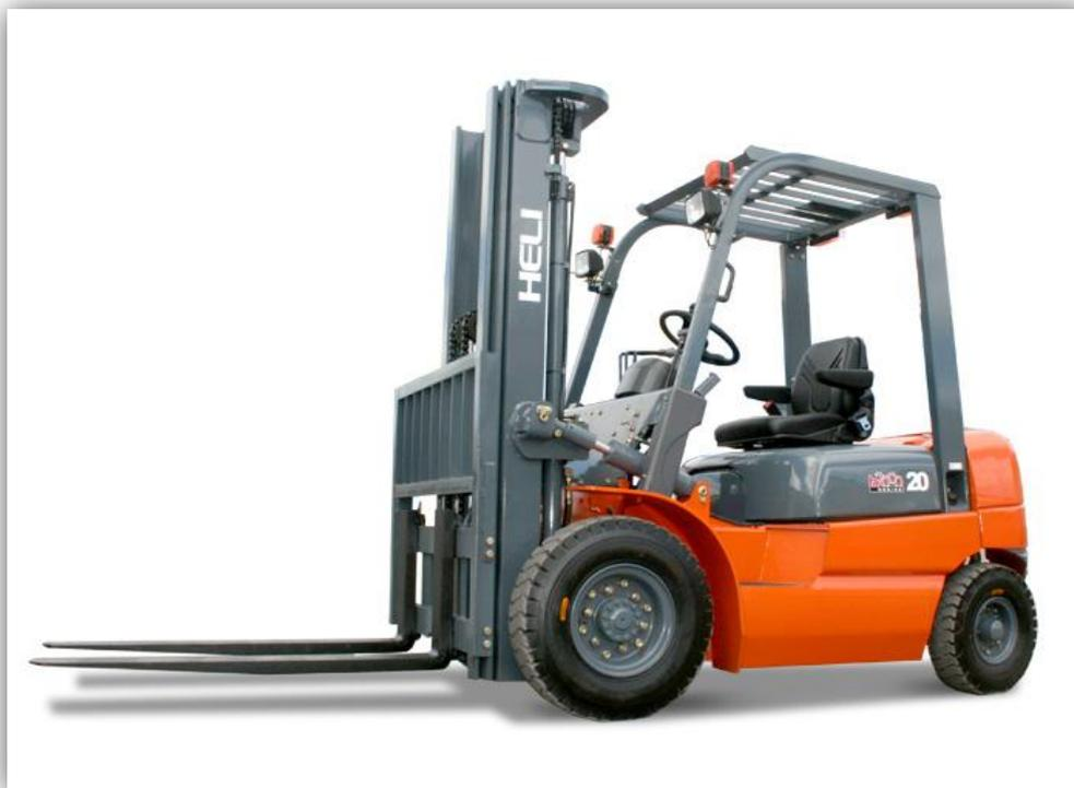
Дизельный погрузчик **HELI CPCD20** обладает надежной конструкцией, проверенной годами эксплуатации в тяжелых российских природных условиях. Благодаря компактному размеру и своей грузоподъемности погрузчик HELI CPCD20 готов проводить погрузочно-разгрузочные работы весом до 2 тонн.
